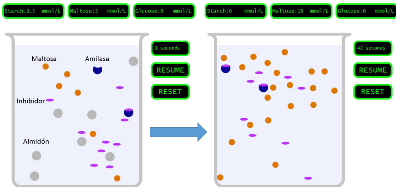
Figura 5. Curso temporal de la reacción enzimática de la amilasa en presencia del inhibidor. Al iniciar la reacción (primer segundo) se tiene 3.5 mM de almidón (starch) y de maltosa 3 mM. En contraste, a los 42 segundos, ya el almidón fue completamente degradado y la concentración de maltosa alcanzó el 10 mM.
